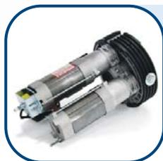
Электродвигатели Н1003 и Н1103 могут быть объединены, в случае необходимости, со вторым параллельным электродвигателем для увеличения мощности привода. Таким образом, привод с одним двигателем версии работает с рольставнями весом до 120 Кг, а с двумя двигателями - до 200 Кг.
