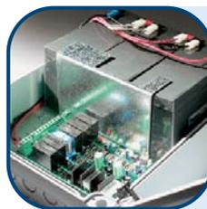
Блок резервного питания LB18 и комплект аккумуляторов гарантируют надежность и безопасность работы автоматических ворот в условиях нестабильного электропитания.
