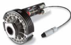
Самоблокирующийся привод 230В для монтажа на вал 48/60 мм с пружиной 200/220 мм с механизмом разблокировки
