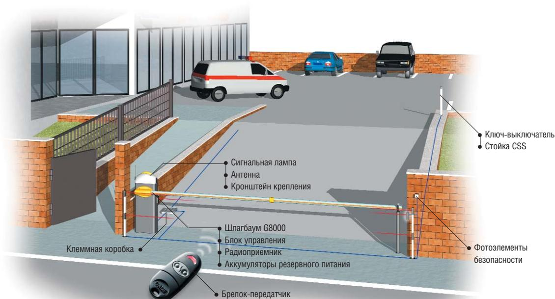
**СТАНДАРТНАЯ КОМПЛЕКТАЦИЯ ДЛЯ ПРОЕЗДА ШИРИНОЙ ДО 8М (=24В)**
