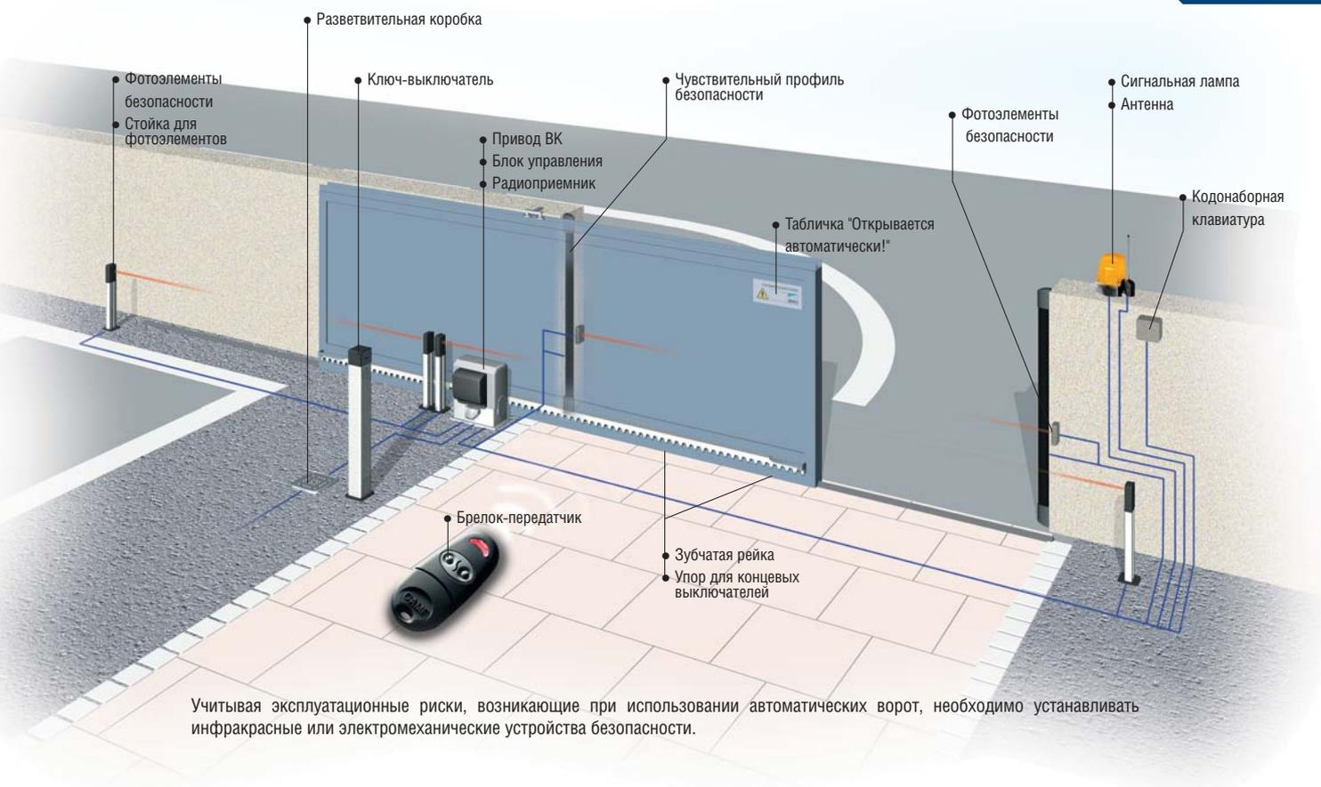
Учитывая эксплуатационные риски, возникающие при использовании автоматических ворот, необходимо устанавливать инфракрасные или электромеханические устройства безопасности.
