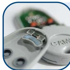
Версия TOP-SA может оснащаться электронным ключом "TAG transponder", легко размещаемым внутри корпуса, и совмещать радиоуправление с контактным доступом
