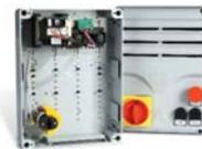
Корпус блока управления из ABS-пластика 240x320 мм с трансформатором и встроенными в корпус выключателем питания и кнопками управления
