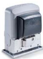
Автоматический привод с 230В двигателем для ворот массой до 1200 кг, (Lмакс=13 м), и определением конечных положений по кодеру. Мод 4.
