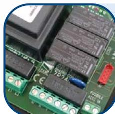
Блок управления ZR24 позволяет автоматизировать рольставни в соответствии с действующими нормами безопасности. Имеет возможность подключения дистанционного радиуправления. (Блок ZR24)
