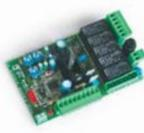
Плата блока управления (стандартная) двумя приводами с разъемом для установки радиоприемника CAME.
