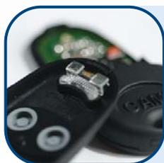
Пульт АТОМО может оснащаться электронным ключом «TAG transponder», легко размещаемым внутри корпуса, и совмещать радиоуправление с контактным доступом
