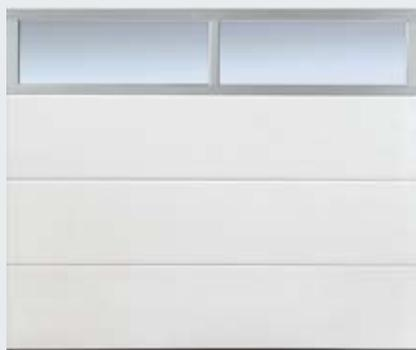
Для всех типов ворот и боковых дверей с гофрами и поверхностью Woodgrain или Silkgrain. Рама остекления: алюминиевые профили, анодированы по DIN 17611, протравлены в натуральный цвет E6/C0 (прежде: E6/EV1), по желанию – в цвет ворот. Остекление: в зависимости от типа ворот одинарное или двойное пластиковое остекление, прозрачное или с кристаллической структурой. По желанию – нестандартное остекление и тянутая решетка.
