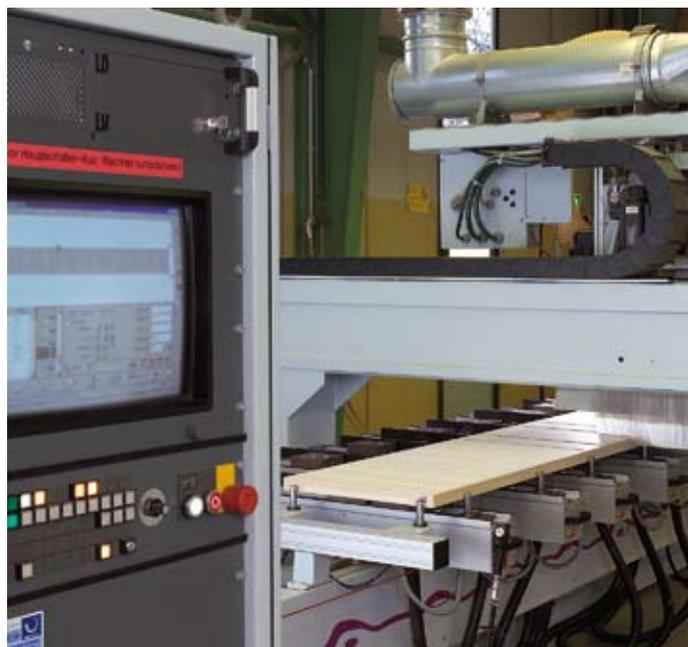
Прецизионная фреза с компьютерным управлением с точностью перенесет Ваш эскиз на деревянные панели ворот.
